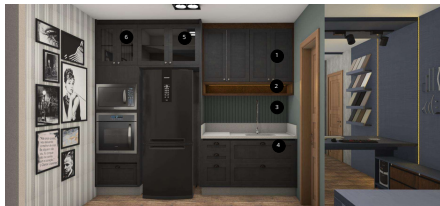
DT-01 PRATEIRA RECLUADA A 30 MM DO FUNDO PARA RECEBER FITA DE LED
